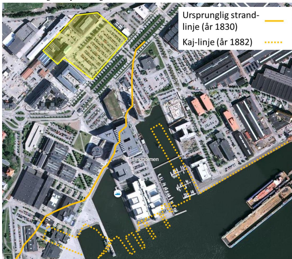
Figur 3 Planvy som visar ungefärligt läge för tidigare strand- och kajlinje, från 1830, resp. 1882, i relation till nuvarande bebyggelse. Placeringen av linjerna är baserad på en äldre karta som kan ses i Rapport, RGeo , utförd av Bo Alte m.fl., listad i kapitel 2.
